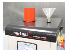
Tolva de vertido de arena automática y tolva aditivos
