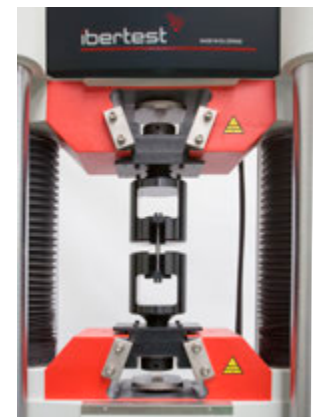
Cabezales de tracción "tipo campana" para ensayo de tracción de probetas metálicas mecanizadas, con cabeza
