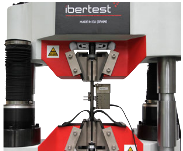
Ensayo de tracción sobre probeta cilíndrica, con medición de la deformación por medio de un extensómetro pinzable IB-MFA20
