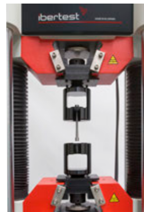
Cabezales de tracción "tipo campana" para ensayo de tracción de probetas metálicas mecanizadas, con cabeza
