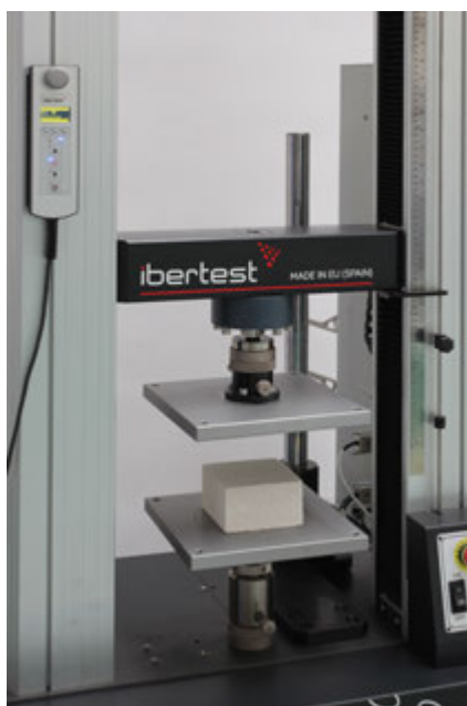
Ensayos a compresión con platos cuadrados. IBERTEST suministra platos redondos, cuadrados y rectangulares para cualquier tamaño de probeta
