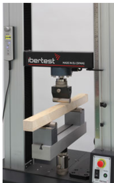
Ensayo de flexión. Es posible realizar ensayos con carga repartida en dos puntos con un doble punzón de carga.
