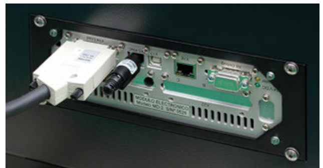
Módulo de control integrado en el bastidor de una máquina EUROTEST
