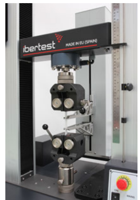
Ensayo a tracción con extensómetro de largo recorrido: permite determinar límite elástico y alargamiento a la rotura de materiales con alto porcentaje de elongación
