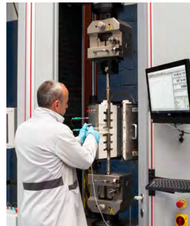
Ensayo de alta temperatura en una EUROTEST-600 con horno.
