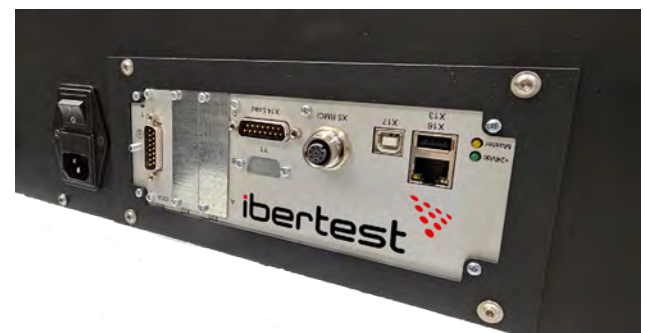
Módulo de control integrado en el bastidor de una máquina TESTCOM
