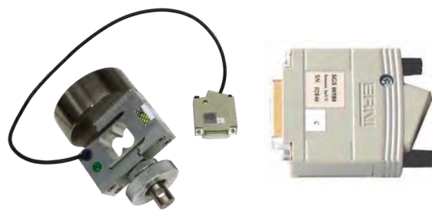
Célula de carga tipo S, de tipo universal (tracción/compresión) de 500 N y su conector con memoria EEPROM incorporada
