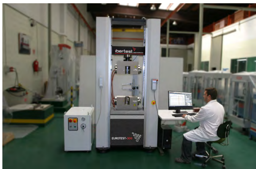
EUROTEST-300 con cabezales hidráulicos de cierre lateral y extensómetro a rotura de alto recorrido.
