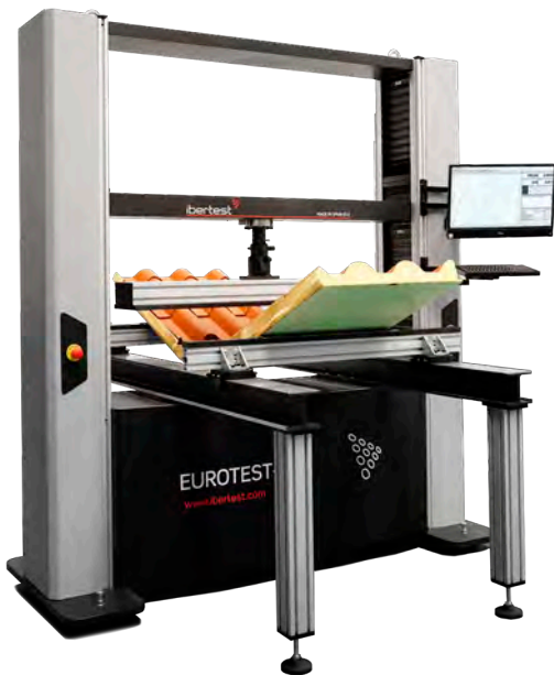
EUROTEST-30E, más ancha, con distancia extra entre columnas y puente de flexión de 3 metros de longitud
