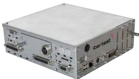
Módulo MD2i, en caja de seguridad, para integrar en el bastidor o en el cuadro eléctrico de la máquina de ensayos
