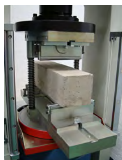
Resistencia a la flexión de hormigón, según EN 12390-6
