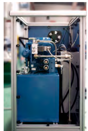
Interior del pupitre, mostrando el grupo hidráulico
