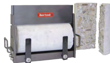
Tracción indirecta según EN 12390-6 (Ensayo Brasileño)
