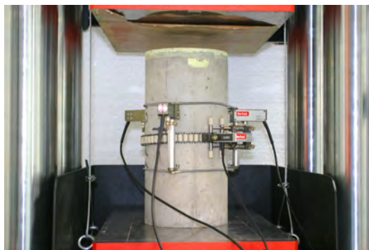
Elasticidad en compresión: determinación del Módulo de Young y Coeficiente de Poisson
