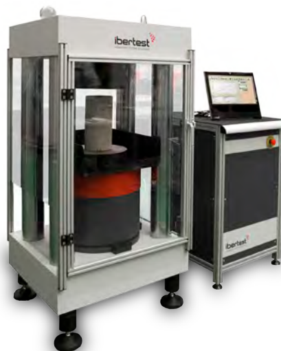
MEH LC 2000 MD2 W con software de ensayos WinTest32 y ordenador PC de sobremesa
